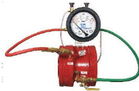
Gambar 11 — Flow meter portabel dengan selang merah (suction) dan hijau (discharge), dilengkapi gauge pembacaan langsung untuk uji performa pompa tanpa membuang air.
